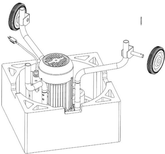
3. Nasuňte kolo a poté podložku na jeden ze dvou držáků a oba prvky zajistěte závlačkou. Pro instalaci druhého kola opakujte tento postup na opačné straně.
